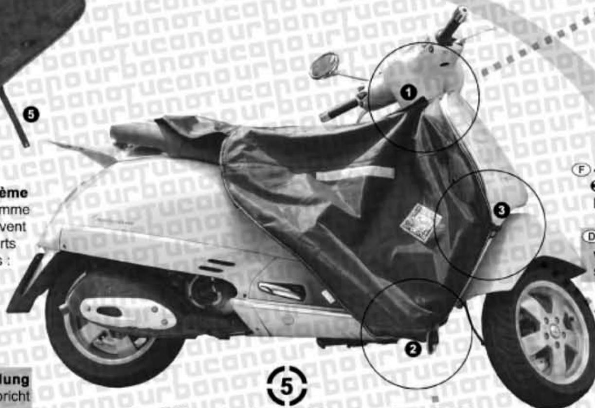
**3** (F) - Fixer les mousquetons des rubans oranges **3**, aux bords de la carrosserie, dans le logement de la roue avant.
