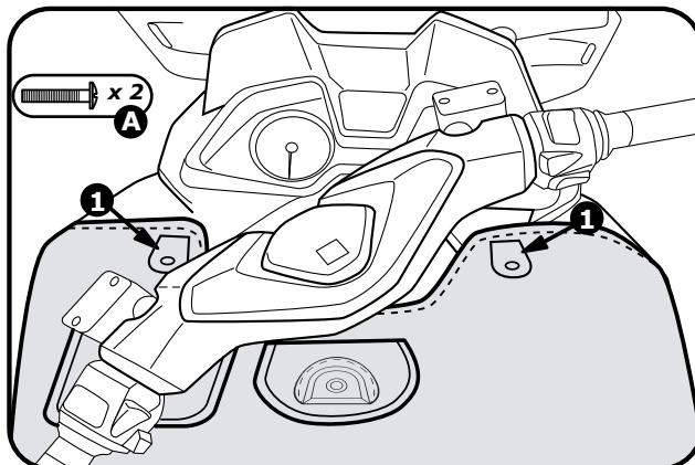
**F** Fixer Termoscud® sur les deux côtés, à l'aide des vis (A) (il est préférable d'utiliser les vis livrées) et les faire passer dans les trous pratiqués sur le Termoscud® aux points 1.
