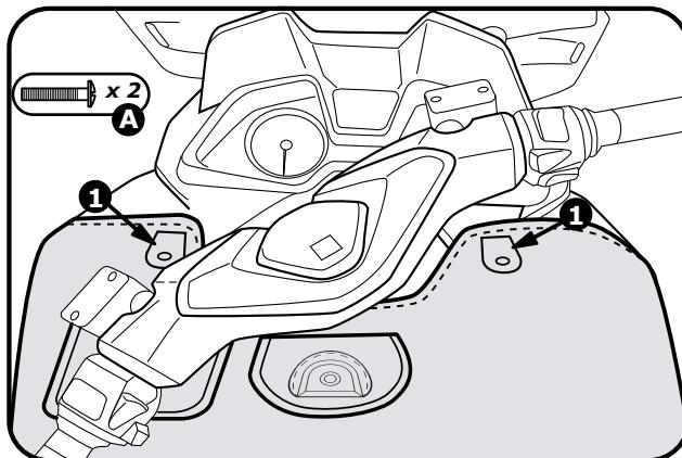
**I** Fissare Termoscud® da entrambi i lati, utilizzando le viti (A) in dotazione, facendole passare attraverso i fori nei punti 1 sul Termoscud®.
